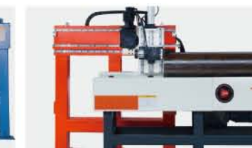
管道定长输送系统 Length setting system
