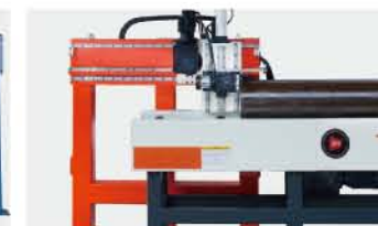
管道定长输送系统 Length setting system
